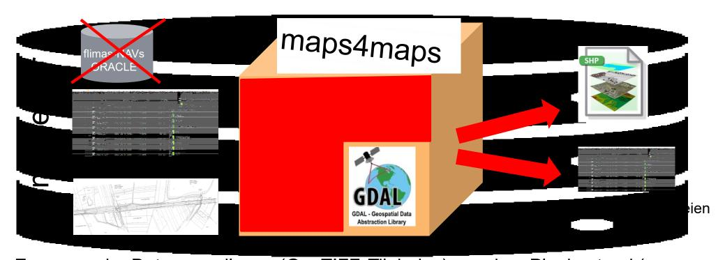
Erzeugen der Datengrundlagen (GeoTIFF, Tileindex) aus dem Planbestand (ca. 58.000 TIF-Dateien, Georeferenzierung über Intergraph Headermatrix) mittels MS Access, VBA und GeoMedia-Komponenten (\*.dll; \*.ocx).
